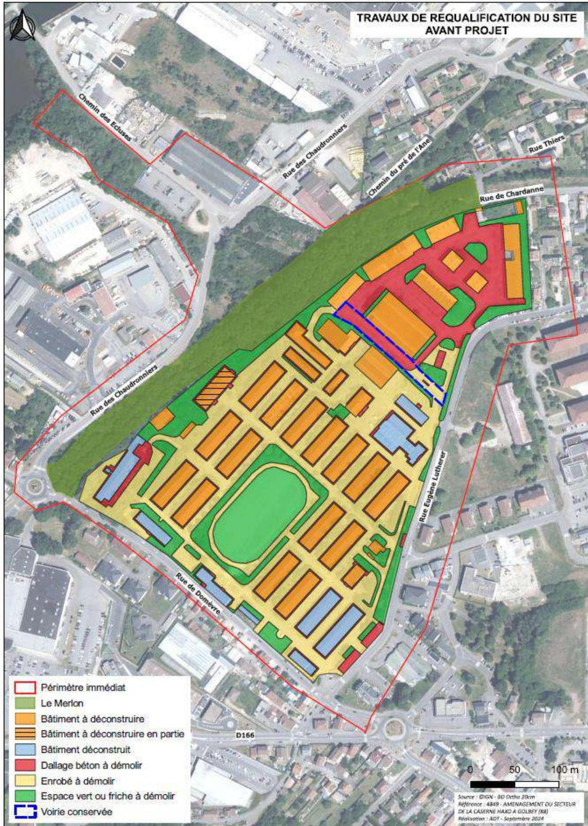
Figure 16 : Carte des travaux réalisés ou à réaliser par l'EPFGE
